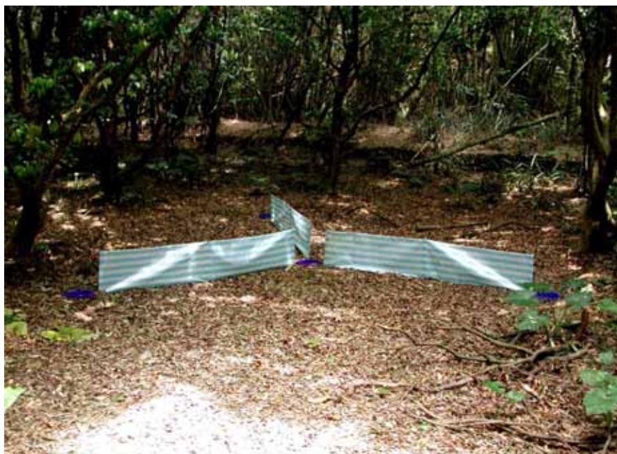
圖 1-1. 攔截籬掉落桶裝置圖(莊銘豐 攝)。
